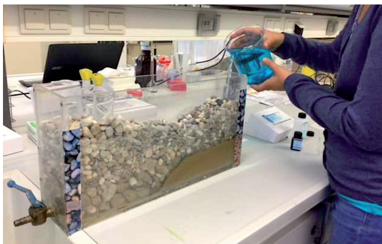
7. ábra. A telített és a telítetlen zónában való vízmozgás modellezése domborzattal tagolt medencében (fotó: Vásárhelyi Dalma)
