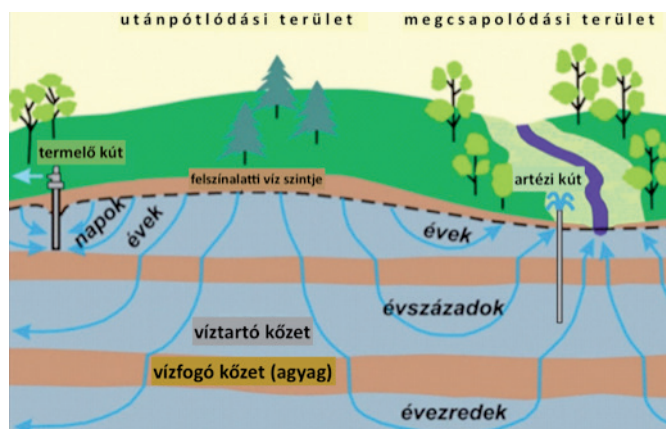
3. ábra. A vízáramlási rendszerek víztartó és vízfogó rétegeken való áthatolásának időléptéke (forrás: Földrajz 9. osztály újgenerációs tankönyv, 171. p.)
