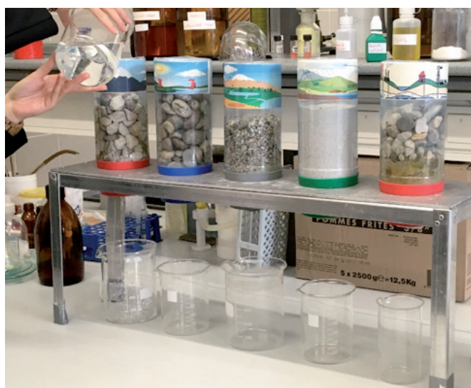
6. ábra. A kőzetek eltérő vízáteresztő képességének vizsgálata (fotó: Deák Anita)
